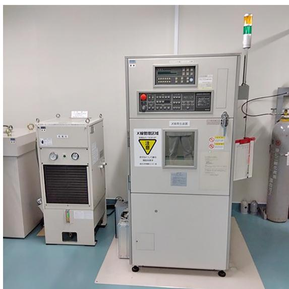
写真2 小動物用X線照射装置
